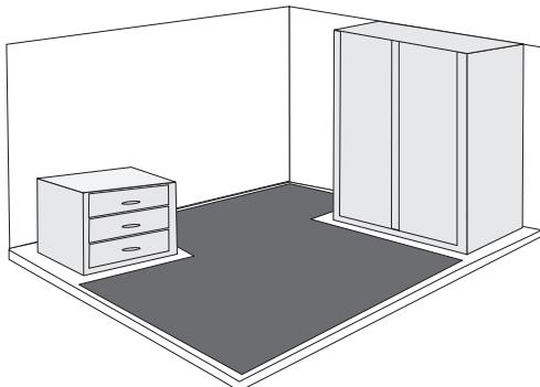
3) Под полученную полезную площадь подберите нагревательный мат, площадь которого примерно равна или меньше площади обогрева. Внимание! Площадь нагревательного матта не может превышать полезную площадь обогрева.
