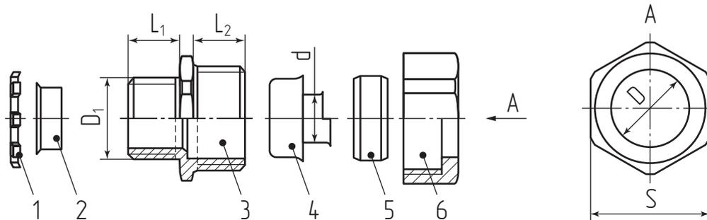
1 – Гайка прижимная    3 – Корпус    5 – Уплотнитель металлорукава
