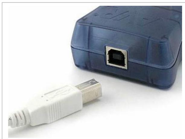
Если USB-драйвер установлен, то при подключении AVRISP mkII к компьютеру должен загореться зелёный светодиод, расположенный внутри корпуса рядом с USB-разъёмом. Главный светодиод состояния останется красным до подключения к программируемому устройству.
