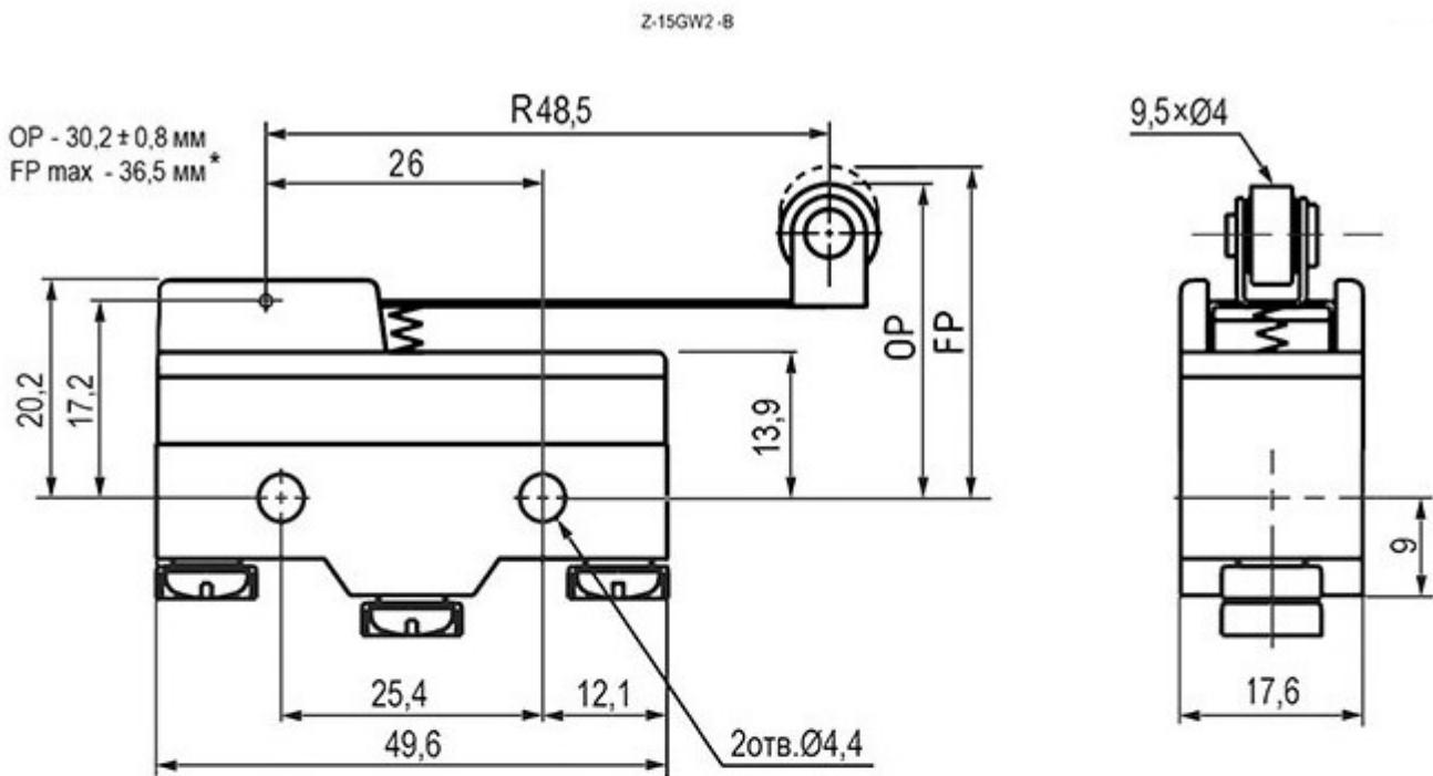
**Тип переключателя Микропереключатель серии Z-15G с роликовым рычагом**
