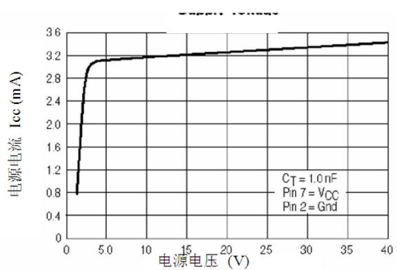
静态工作电流—工作电压特性曲线
