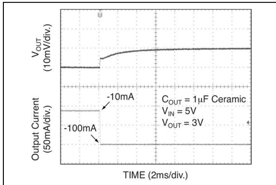
**FIGURE 2-13:** Load Transient.
