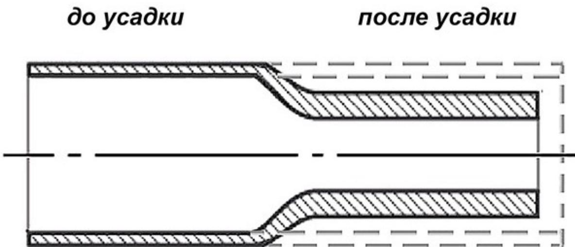
**Тип Трубка термоусадочная неподдерживающая горение
