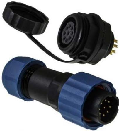
Герметичный разъем (комплект) с заглушкой SZC16 9P-M-FB, вилка-розетка, 9 контактов, диаметр входящего кабеля 8 мм, IP68, 5 А, 250 В, является пылезащищенным и влагозащищенным. Герметичный разъем соответствует высокой степени защиты, что гарантирует работу разъемов при длительном погружении в воду (более 30 минут) на глубину больше 1 м.
