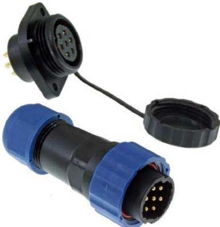
Герметичный разъем (комплект) с заглушкой SZC21 7P-M-FE, вилка-розетка, 7 контактов, диаметр входящего кабеля 12 мм, IP68, 10 А, 250 В, является пылезащищенным и влагозащищенным. Герметичный разъем соответствует высокой степени защиты, что гарантирует работу разъемов при длительном погружении в воду (более 30 минут) на глубину больше 1 м.
