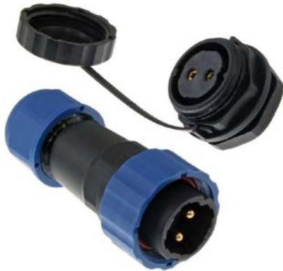
Герметичный разъём (комплект) с заглушкой SZC21 2P-M-FB, вилка-розетка, 2 контакта, диаметр входящего кабеля 12 мм, IP68, 25 А, 250 В, является пылезащищенным и влагозащищенным. Герметичный разъём соответствует высокой степени защиты, что гарантирует работу разъемов при длительном погружении в воду (более 30 минут) на глубину больше 1 м.
