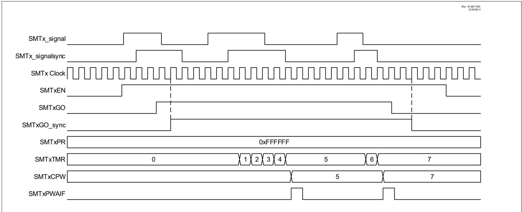
**FIGURE 32-5: GATED TIMER MODE SINGLE ACQUISITION TIMING DIAGRAM**
