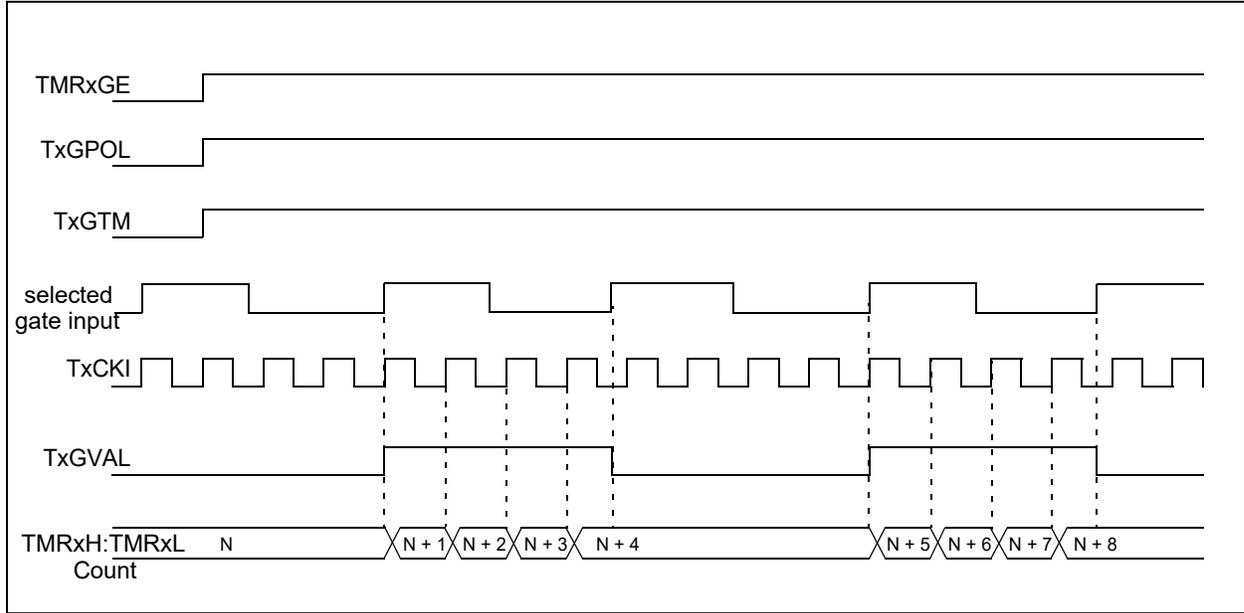
**FIGURE 28-5: TIMER1 GATE SINGLE-PULSE MODE**
