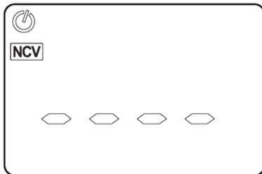
2) Нажмите кнопку «Hz/NCV» и переместите датчик бесконтактного обнаружения напряжения к обследуемому проводнику. Если детектируемое переменное напряжение превышает 90 В, то мультиметр обнаружит наличие напряжения. При этом замигает лампа подсветки, и включится звуковой сигнал.
