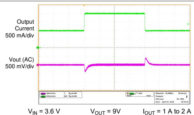
**Figure 9-7. Load Transient**
