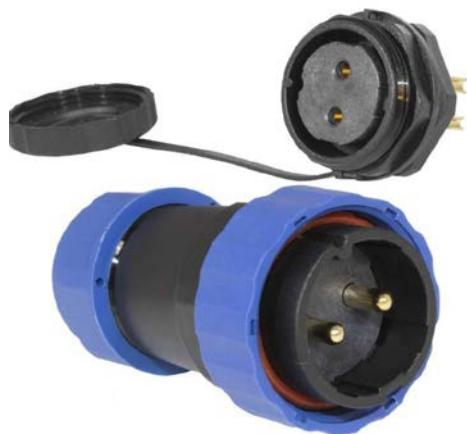
Герметичный разъем (комплект) с заглушкой SZC28 2P-M-FB, вилка-розетка, 2 контакта, диаметр входящего кабеля 15 мм, IP68, 5 А, 250 В, является пылезащищенным и влагозащищенным. Герметичный разъем соответствует высокой степени защиты, что гарантирует работу разъемов при длительном погружении в воду (более 30 минут) на глубину больше 1 м.
