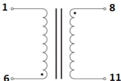
Электрическая схема трансформатора с двумя выходами:
